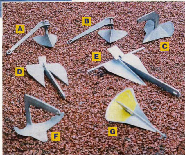
A CQR 10 lb – 4.8 kg, 480 sq cm; B HiBlade 10 lb – 4.7 kg, 510 sq cm; C Delta 6 kg – 6.7 kg, 620 sq cm; D Brittany 6 kg – 6.2 kg, 560 sq cm; E Danforth 6 kg – 6.2 kg, 610 sq cm; F Bruce 5 kg – 4.9 kg, 300 sq cm; G SPADE 6.5 – 5.1 kg, 460 sq cm
